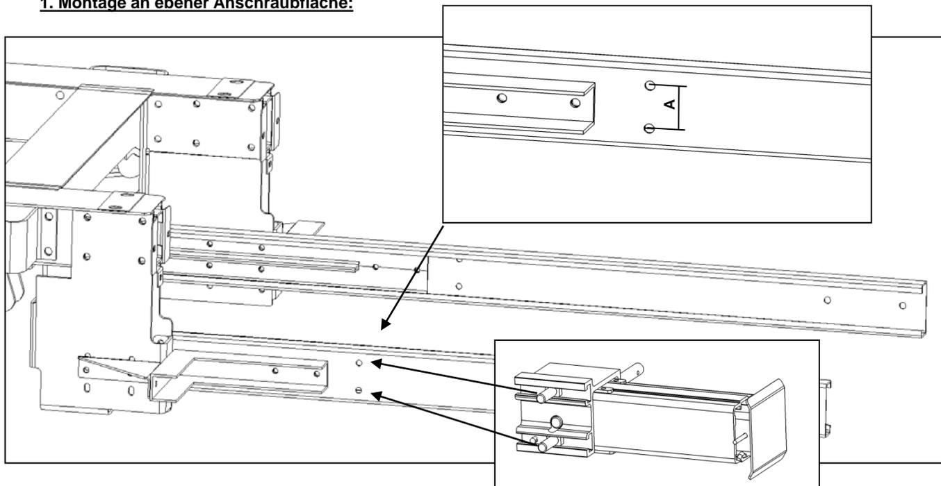
Falls noch keine Bohrungen in der Rahmenverlängerung vorhanden sind, müssen diese noch eingebracht werden. Abstand A= 51mm, Bohrungsdurchmesser 11mm.
